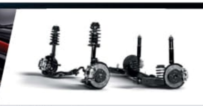
ระบบช่วงล่างที่นุ่มนวลและมั่นคง ระบบกันสะเทือนหน้าอิสระแบบแมคเฟอร์สันสตรีก พร้อมเหล็กกันโคลงด้านหลังแบบทอร์ชันบาร์และคอสส์สปริง พร้อมเหล็กกันโคลงเชิงตรง ให้การทรงตัวที่เสถียรภาพในทุกสภาพถนนและทุกสถานการณ์ของการขับขี่
